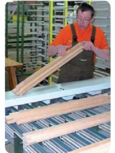
Für ewitherm® Holzfenster und -Türen werden nur Hölzer in makelloser Qualität verwendet. Das Premium-Auswahl-Verfahren bildet damit die Basis für die Konstruktion hochfester, lamellierter, extrem haltbarer und schichtfestverleimter Holz-Riegel.
