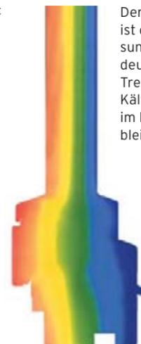
Der gute Isothermenverlauf ist durch die Wärmebildmessung sichtbar gemacht: deutliche Darstellung der Trennungen von Wärme und Kältezonen. Die Wärme wird im Haus gehalten, die Kälte bleibt ausgesperrt.
